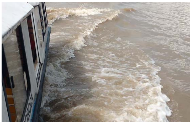
Figura 6.21. Trem de Ondas Divergentes a 17 km/h
