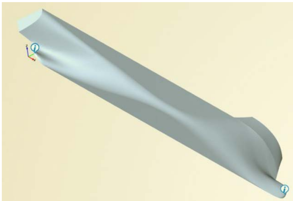
Figura 3.7. Sistema de Coordenadas Padrão do SHIPFLOW, x + na Direção Contrária ao fluxo, z + na Direção para Cima e y + na Direção para Bombordo .
