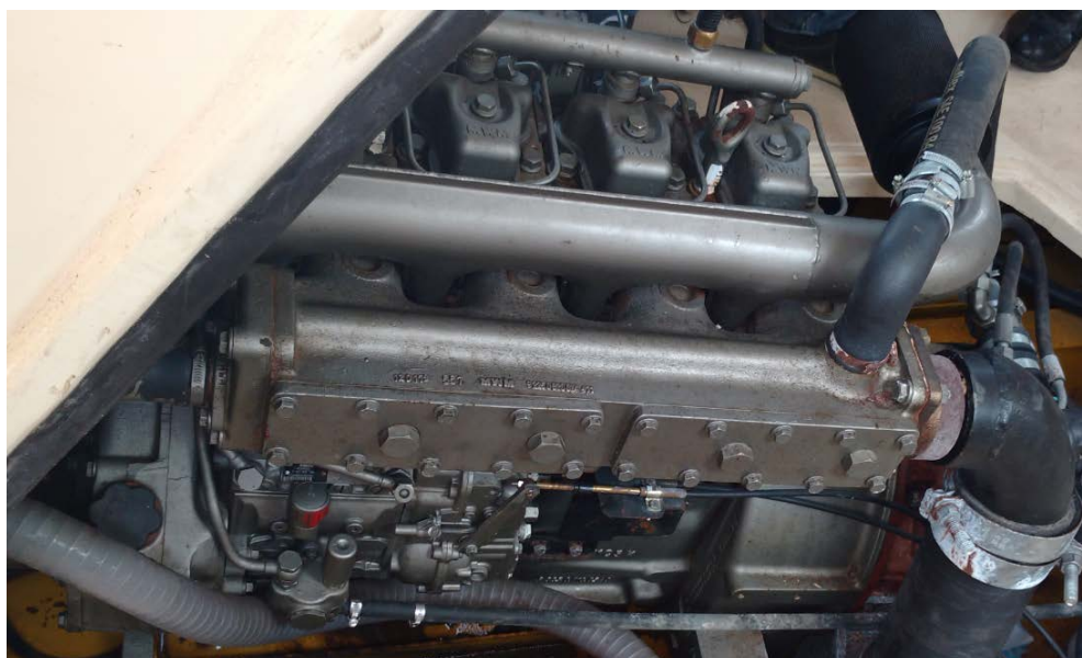
Figura 6.20. Motor da LE-M, um MWM série 229 de 4 Cilindros
