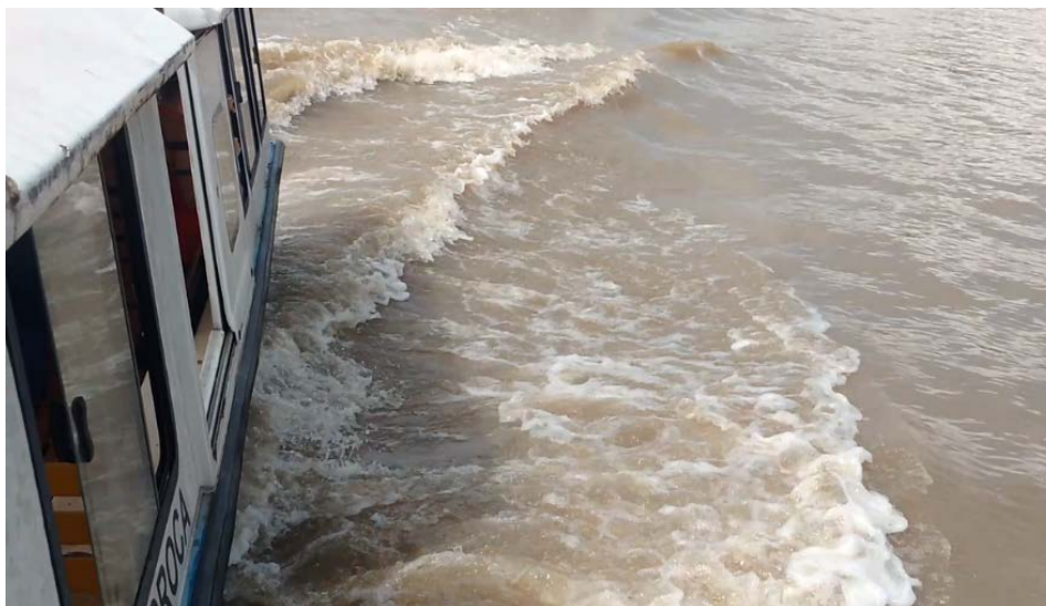
Figura 1.3. Trem de Ondas Incidentes a 17 km/h ( F_n = 0,54 )
