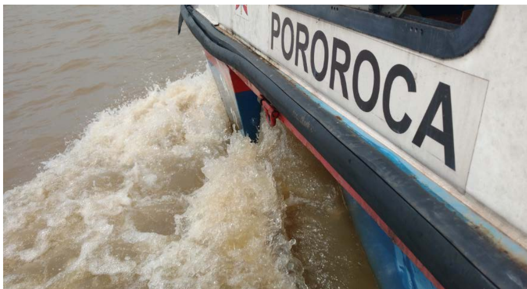
Figura 1.2. Onda Incidente Gerada na Região da Bolina a 17 km/h ( F_n = 0,54 )
